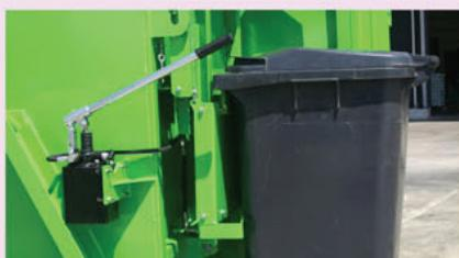
Ruční hydraulické čerpadlo
