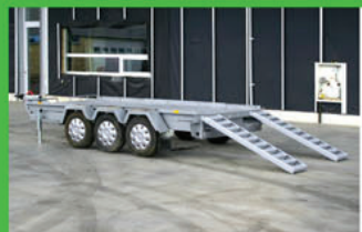
Kontejnerový podvalník třísoř 5339-249-4635 délka podlahy 4 000 mm
