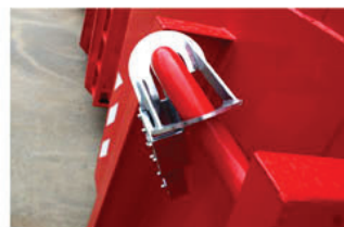
Zámek natahovacího ucha 298-9806 pro výšku háku 1570 mm (DIN30722 díl 1)
