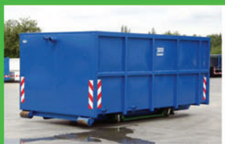
ABL-450PED1000-8.5.0CS 2981-5465-260-6046 objem 8,5 m 3 , délka podlahy 4 500 mm
