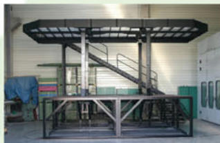
Speciální hydraulické pódium 3043-6136-301-0143 plocha pódia 24 m 2 , zdvih 2,5 m
