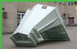
Násypka vnitřní dvoukomorová k CNS 400K 2271-4106-125-2507 ke kontejnerovým nůžkám na kovový šrot
