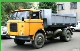
ABL-440PED1250-8.1C 2791-4694-205-0527 objem 8 m 3 , délka podlahy 4 400 mm
