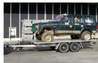
Přívěsný vozík sklopný plošinový 3038-5860-294-9442 délka podlahy 4 000 mm
