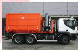
ABL-505KOT1250-17.5.2DS 2465a-5975-293-9306 objem 17,5 m³, délka podlahy 5 050 mm
