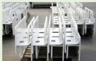
Kabelové ukladače důlního kombajnu 3043/01-6022-294-9457 součást technologie hlubinného dobývání uhlí
