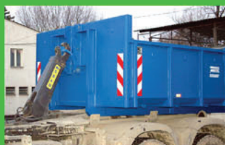
ABL-470PED0750-10.2CS 2333-4562-200-0022 objem 10 m 3 , délka podlahy 4 700 mm
