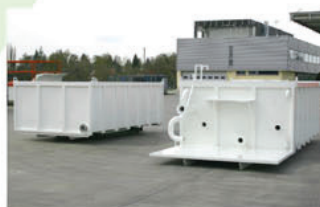
Nádrže na bentonit 2475-6033-293-9381 objem 11 m 3 , délka podlahy 5 500 mm
