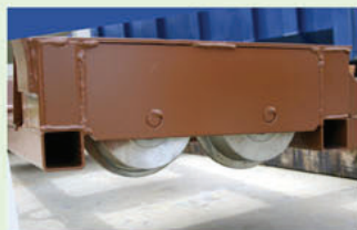
Kolejnicový podvozek kontejnerů 1019a-5844-282-8279 pro kontejnery ABROLL a MULDA, nosnost 18 t
