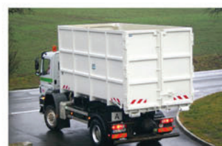
ABL-500PED1250-29.2D 4266-5940-289-8966 objem 29 m³, délka podlahy 5 000 mm
