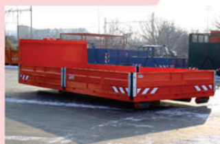
ABL-600PLO0000-7.5.1D 4286-5969-290-9065 objem 7,5 m³, délka podlahy 6 000 mm
