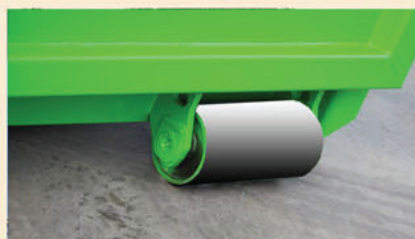
Zapuštěná maznice čepu pojezdové rolny
